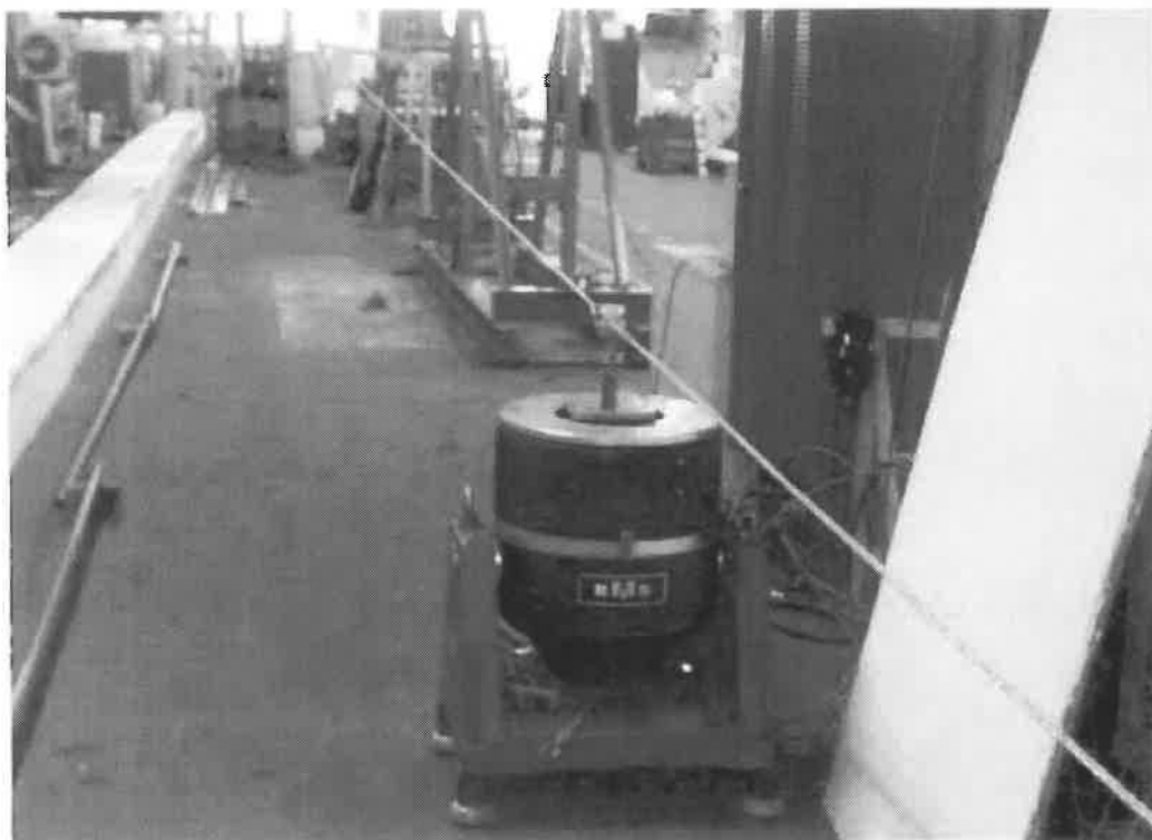
Фигура 7: Устройство за вибрации, изглед към опъвателното устройств
